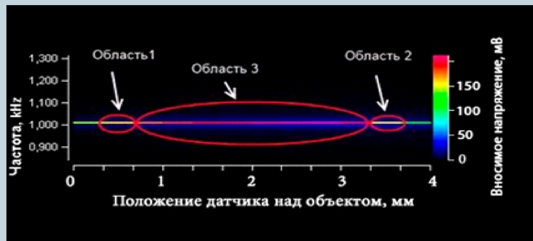
Фурье-образ области образца с дефектом. Области 1 и 2 соответствуют стенкам параллелепипеда, область 3 - его полый части
