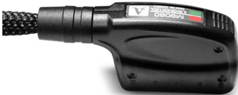
Рисунок 4.3 – Фазированная антенная решетка M9060 4.0V0R40X10CL – 16-элементная АР продольных волн с центральной рабочей частотой 4 МГц и сектором обзора \pm 30^\circ
