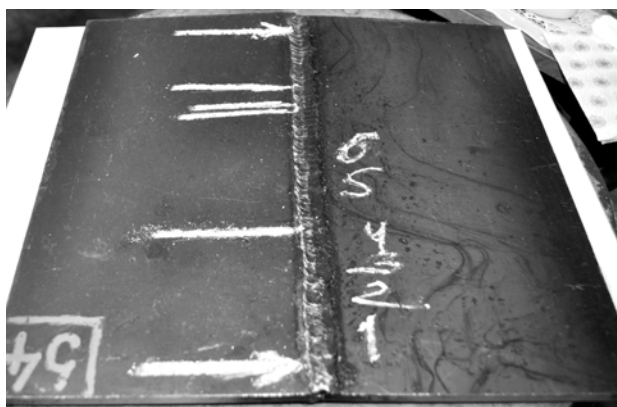
Рисунок 2.3 – Стыковой сварной шов с дефектом типа «непровар» в корне шва, протяженным по всей длине шва
