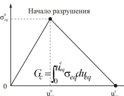
Рис. 3 - Определяющие соотношения для ортотропного поврежденного материала
