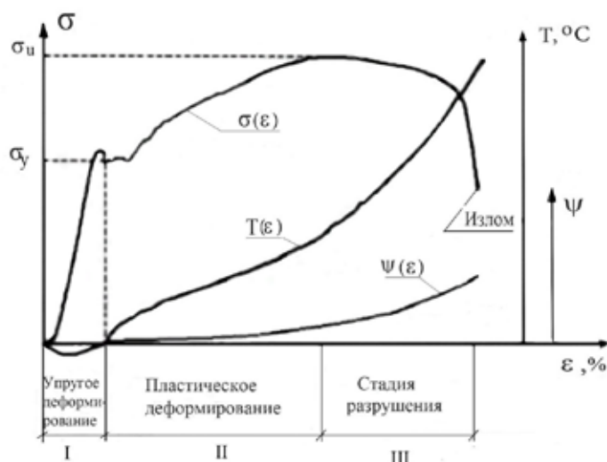
Рис.1. Изменение температуры T образца при увеличении деформации \epsilon (одноосное нагружение): \sigma_u – предел прочности; \sigma_y – предел упругости; \psi - относительное сужение поперечного сечения образца
