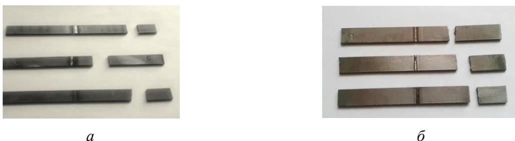
Рис. 1. Результаты испытаний на разрыв: *а* – сталь; *б* – титан
