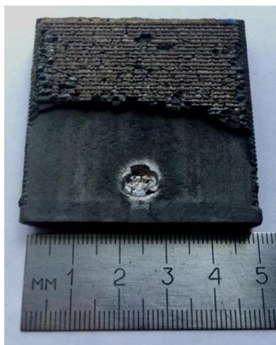
Образец ХГН покрытия с последующей обработкой лазерным излучением после соударения с шариком
