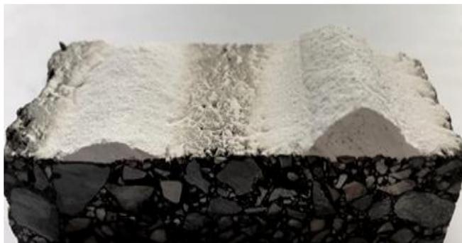
Дорожки напыления на поверхности асфальтобетона, полученные при температурах рабочего воздуха 300 К (слева) и 433 К (справа)
