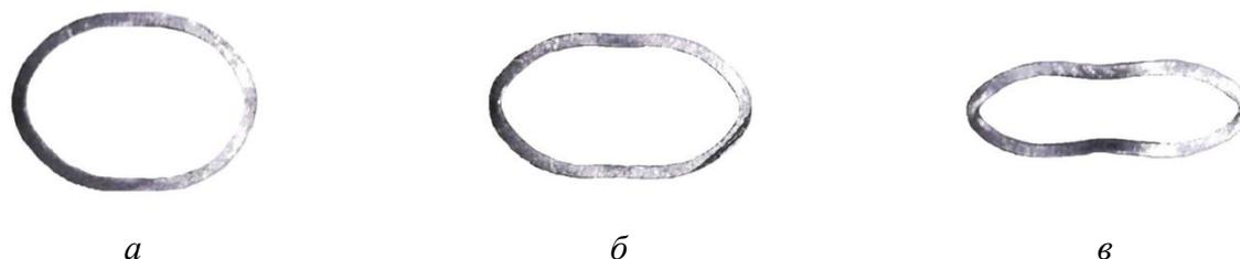
Форма колец после сжатия на 1,5 (а), 2,5 (б) и 4 (в) мм
