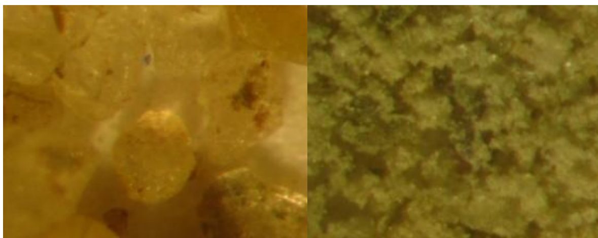
Рис. 3. Зерна речного песка до (а) и после механоактивации (б) х32 кратное увеличение на микроскопе МБС-10)
